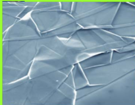
Micrografía electrónica de barrido de una capa arrugada de grafeno
