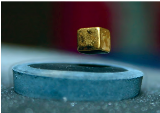
Figura 13. Efecto Meissner. Debido que el superconductor expulsa las líneas de campo magnético, un imán levita sobre un material superconductor.
