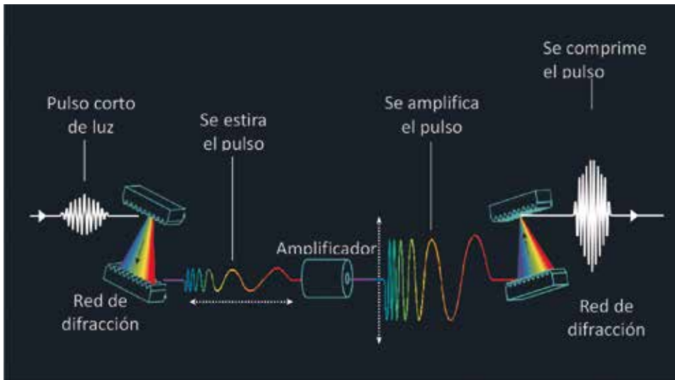
Figura 4. Configuración estándar de CPA. La separación de frecuencias se ilustra con colores. Inicialmente, el medio amplificador era Nd: vidrio, mientras que hoy en día, es más común el Ti: zafiro (reproducido del Centro para Ultrafast Optical Science, Universidad de Michigan en Ann Arbor).
