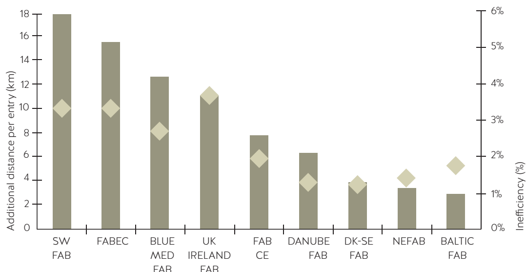
FIGURA 5.2. DISTANCIA ADICIONAL POR VUELO RECORRIDA EN LOS DISTINTOS FAB EUROPEOS (DISTANCIA REAL-DISTANCIA ÓPTIMA)
