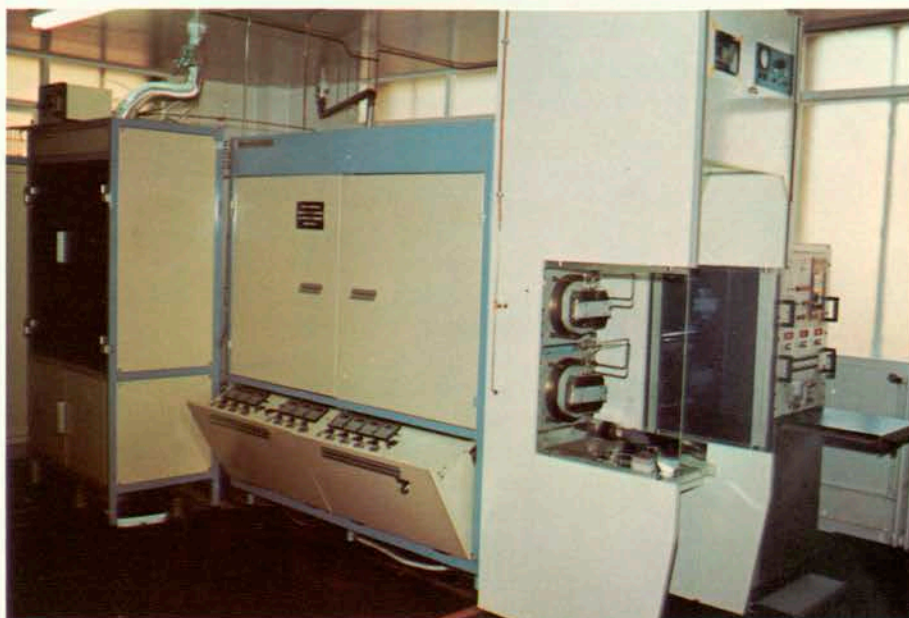
SISTEMA DE EPITAXIA DE SILICIO EN PARED CALIENTE Y BAJA PRESION (LPCVD).
