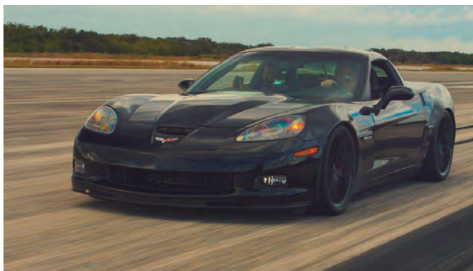
Figura 4. Chevrolet Corvette Z06 en el que su motor gasolina de 500 caballos ha sido sustituido por un sistema eléctrico de 700 caballos. Alcanza una velocidad de 331 km/h. Julio 2016.
