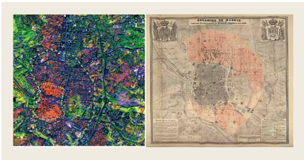
Figura 4. La imagen de la derecha, obtenida con Sentinel 2, recoge la parte central de Madrid, mostrándose el casco antiguo delimitado por una línea punteada amarilla: aparece en tonos rojos intensos debido a la predominancia de cubiertas de teja, que presentan una alta reflectancia en los canales seleccionados. El mismo color ofrecen los pueblos integrados en su día por Madrid, fuera de la segunda línea punteada, en verde, como Tetuán, Pueblo Nuevo y Vallecas. Entre las líneas punteadas se muestra el segundo cinturón, correspondiente al Ensanche de Madrid. Sus barrios se reconocen visualmente, además, por su ordenación planificada en cuadrícula. Los tonos azulados se corresponden con materiales de techado diferentes, como los conglomerados y los basados en áridos. En el casco antiguo, estos tonos azulados muestran con claridad los nuevos materiales introducidos con la apertura de la Gran Vía entre 1910-1932 para comunicar la zona de Arguelles y Salamanca y descongestionar la zona central. La segunda imagen de la derecha es el mapa del Anteproyecto del Ensanche de 1861, y muestra esta diferenciación espacial entre el Casco Antiguo y Ensanche. Sentinel-2. Elaboración propia.
